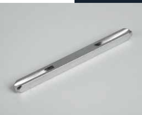
ART 140 Ferro C/ Fres. rettangolari da 1 o 2 lati Superficie : Zincata Tropic. Disponibilità : Q.7 / 8 / 8,5 Lunghezza a richiesta
