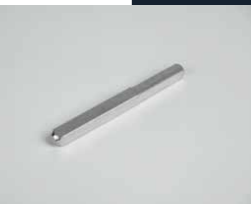
ART 150 Ferro Q.7 ridotto da 1 o 2 lati a Q.6 Superficie : Zincata / Tropic. Disponibilità : Q.7 Lunghezza riduzione a richiesta
