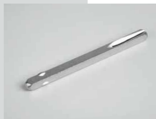
ART 180 Ferro C/Fres. e taglio da 1 lato + cianfrinatura Superficie : Zincata / Tropic. Disponibilità : Q.7 / 8 Distanza cianfr. a richiesta
