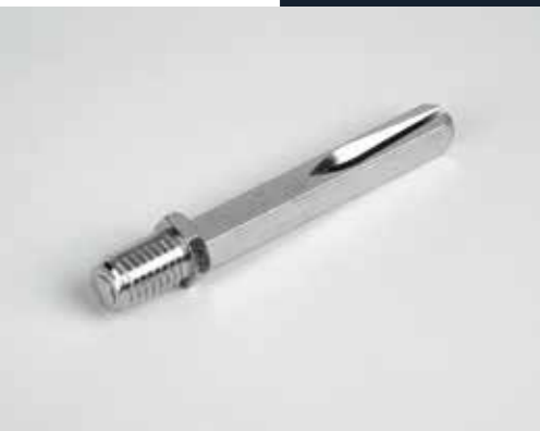
ART 205 Ferro C/Fres. e taglio da 1 lato + Niplex Girevole 8MA / 10MA 12MA 14MB per 19 / 20 MM Superficie : Zincata / Tropic. Disponibilità : Q.7 / 8 / 8,5 / 9 / 10 Lunghezza a richiesta CH 12 / 14 / 17
