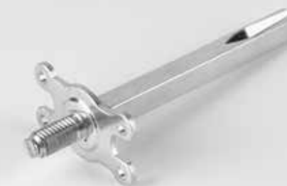
ART 311 Piastrina di fissaggio Topolino C/Filetto M8x25 snodato Superficie : Zincata / Tropic. Disponibilità : Q.8 Lunghezza a richiesta
